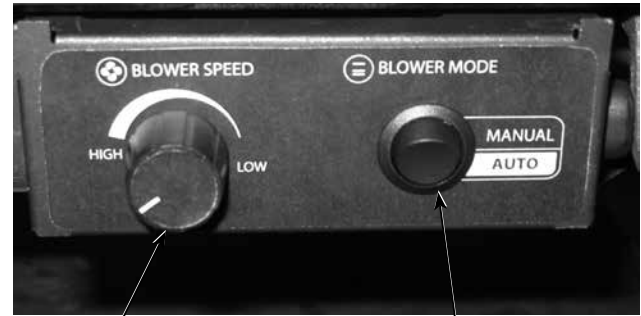
Blower Speed Control Knob (rheostat)
